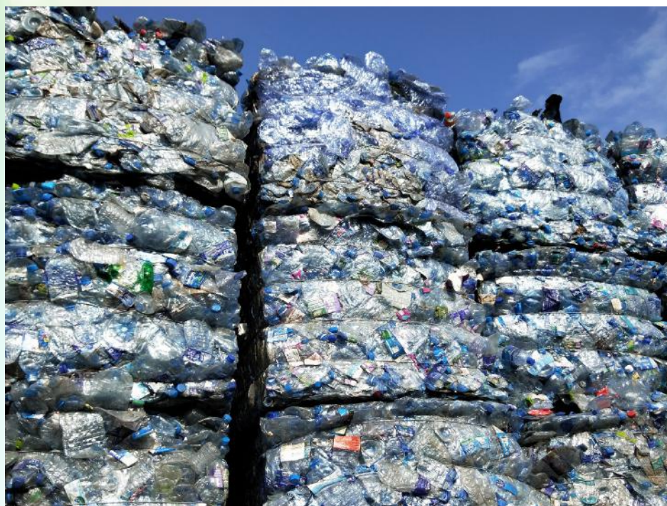
單一塑膠材質及單一型態- 對苯二甲酸酯乙二酯(PET)瓶 (含少量瓶蓋及標籤)
